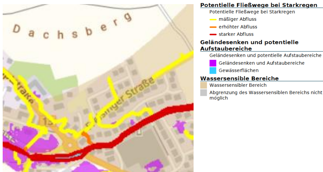
Abb. 7: Hinweiskarte Oberflächenabfluss und Sturzflut 6
